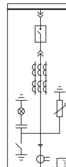
3 Шкаф с силовым выключателем. Ввод/вывод кабелем снизу.
